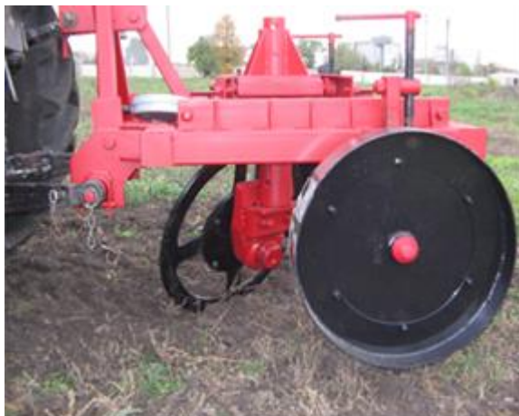
Рис.1 – Загальний вид тензометричного візка (на фото зображений варіант з жорстким стояком ;
